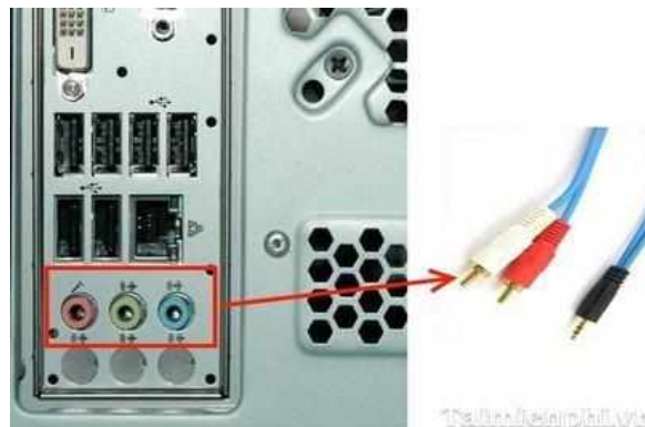
Hình 1.8: Cổng kết nối với các thiết bị âm thanh
