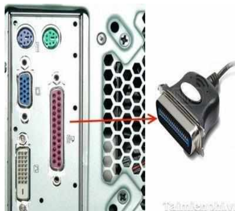
Hình 1.4: Cổng kết nối với các thiết bị ngoại vi chuẩn Parallel
